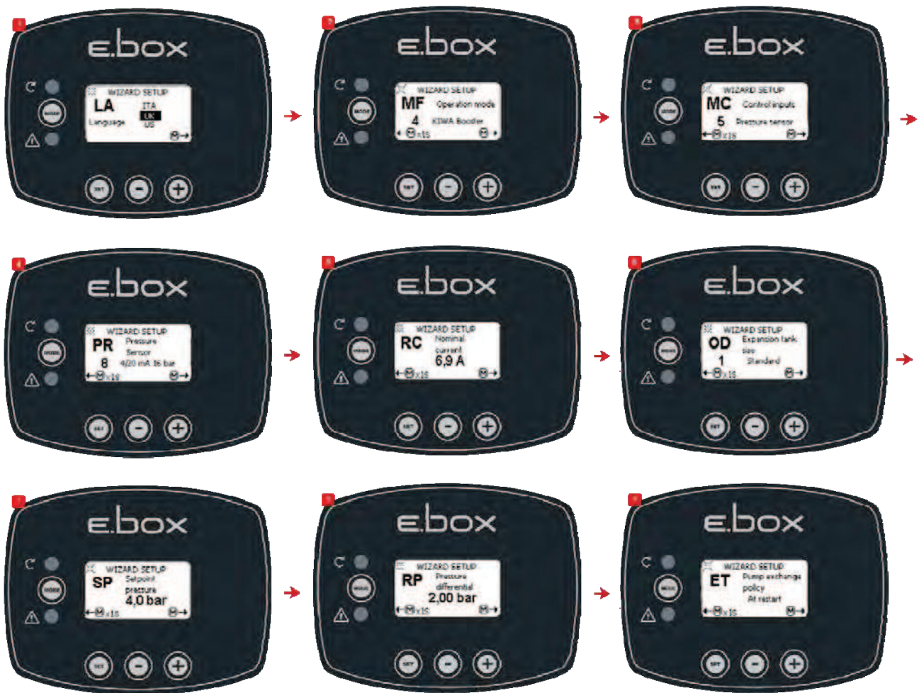
Figure 48 : Pressurisation KIWA avec capteur de pression
