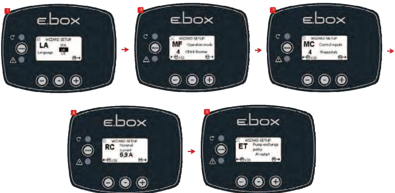
Figure 49 : Configuration KIWA avec des pressostats
