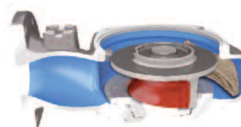
Etape 2 : la rainure de dégagement et le guide pin du fond de volute évacuent les solides, tels que les chiffons.
