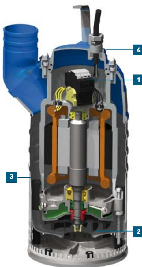
garnitures mécaniques d'arbre en carbure de silicium assurent à la pompe un fonctionnement irréprochable.
